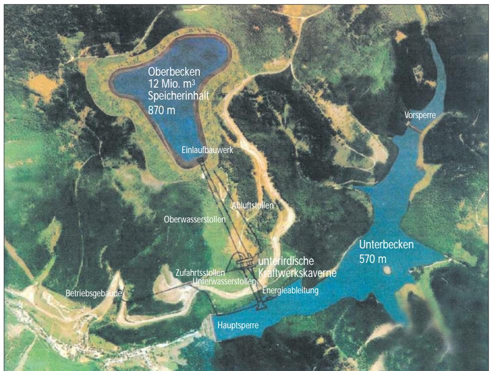
Bild 6. Pumpspeicherkraftwerk Goldisthal, 1 060 MW, 8,5 GWh
