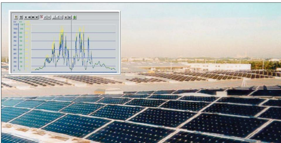
Bild 4. Solargenerator München 1 MW, 1 000 MWh/a – die Kurve zeigt den Leistungsverlauf am Tag der Sonnenfinsternis 11.8.1999
