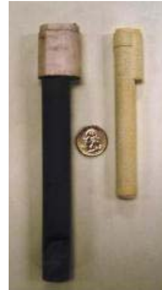
Gen 3.0 und Gen 3.1 Direktoxidations-Brennstoffzellen mit je 3W
