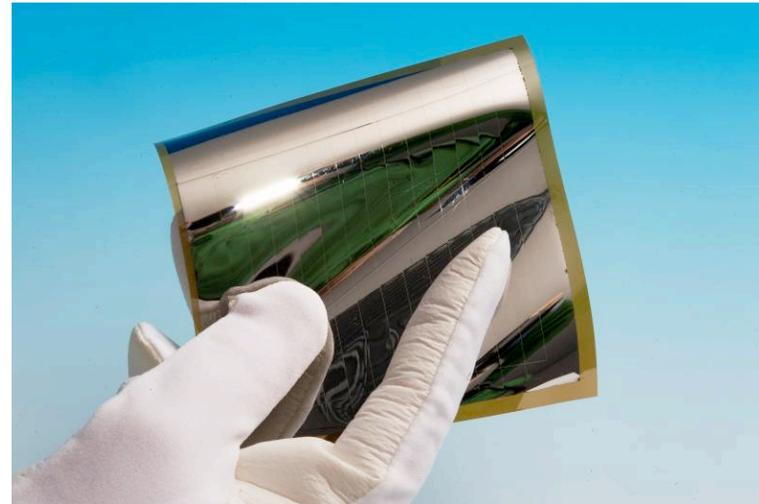
Flexible CIS-Solarmodule (ZSW)
