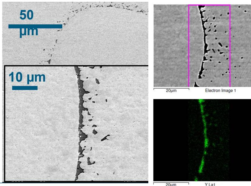
1  $\mu\text{m}$  W/1  $\mu\text{m}$   $\text{Y}_2\text{O}_3$  interface
