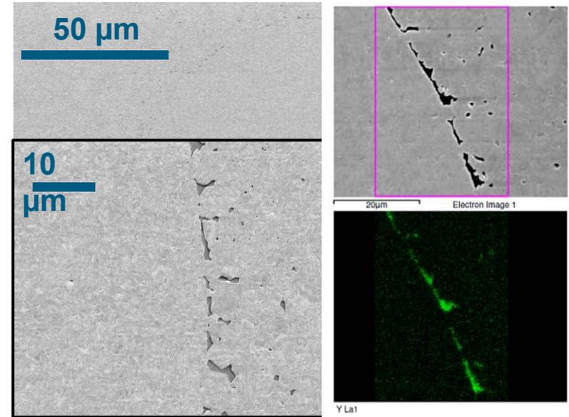
1  $\mu\text{m}$   $\text{Y}_2\text{O}_3$  interface
