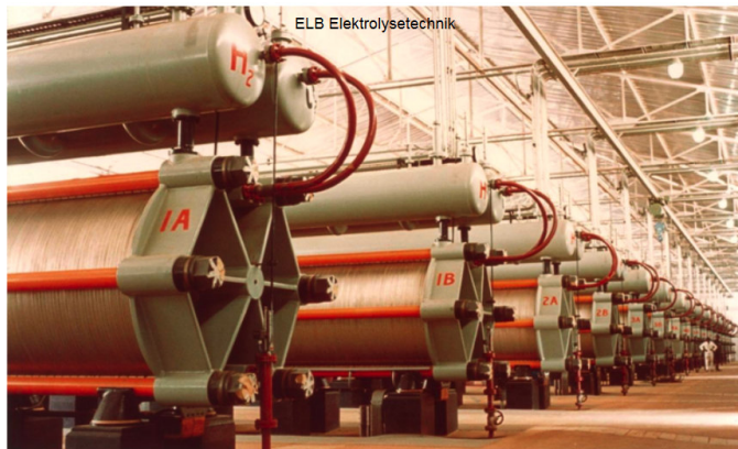
28 Elektrolyseure a 760 m 3 /h H 2 für die Düngemittelherstellung (Zimbabwe) Gesamtkapazität von 21.000 m 3 /h H 2 , installiert in den Jahren 1972 – 1974
