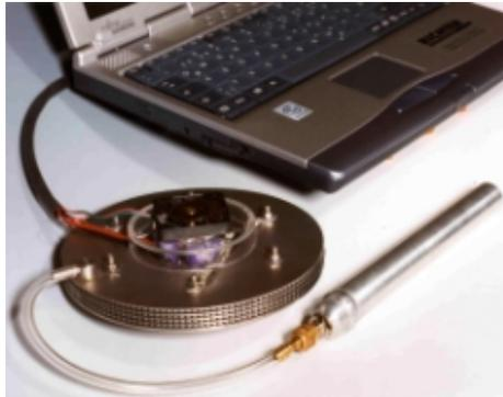
**Bild 12: Kleine portable Brennstoffzelleneinheit (FhG-ISE)**
