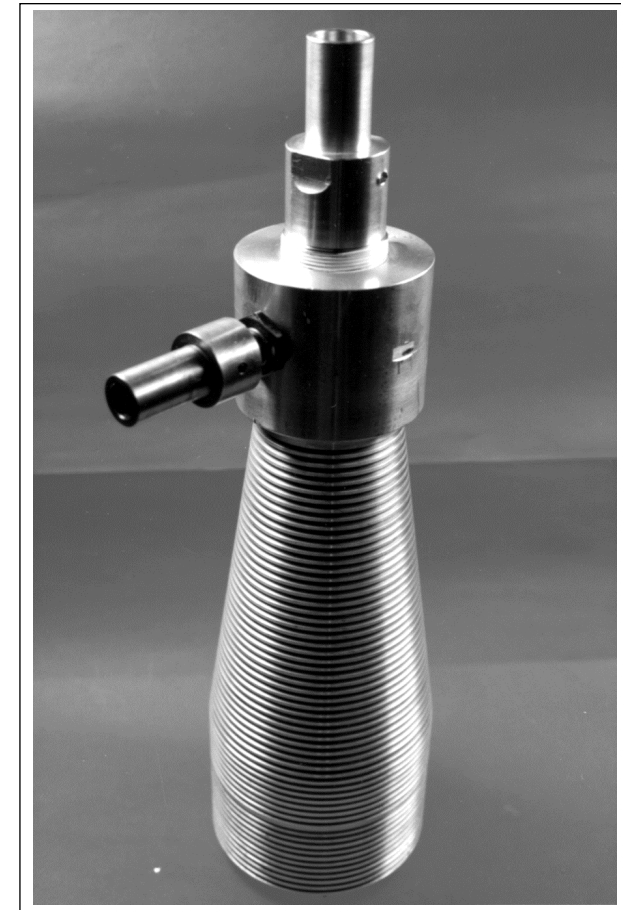
Fig. 15: Wirbelbirne zur gleichzeitigen Expansion und Kühlung technischer Gase [37].
