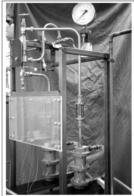
Fig. 6: Wirbelrohr zur Entspannung von Wasserdampf. Das Rohr befindet sich mit lotrechter Achse links oben im Bild. In der Bildmitte unten sind 2 mit Kaltwasser betriebene Kondensatoren sichtbar. Diese werden benötigt, um die aus dem Rohr austretenden Dampfströme zu kondensieren und durch Wägung zu bestimmen.
