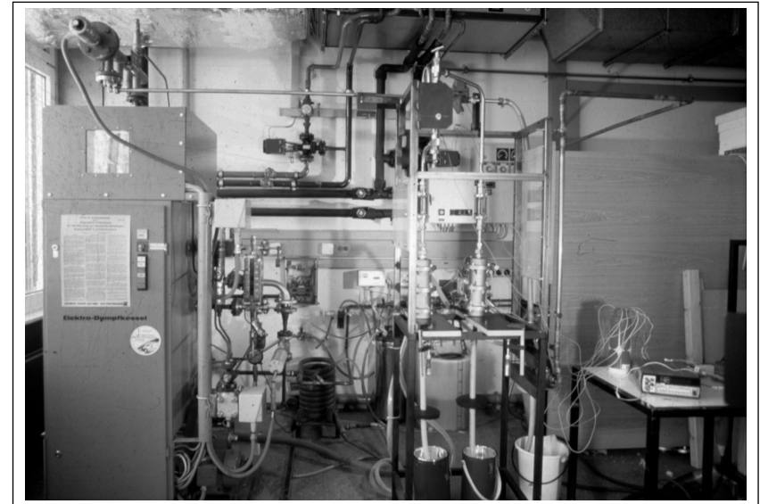
Fig. 7: Versuchsanlage zur Expansion von Wasserdampf bis p_{\max} = 20\text{ bar} im Wirbelrohr [26]. Das eigentliche Wirbelrohr ist in Bildmitte oben in lotrechter Anordnung zu erkennen. Links im Bild die Dampferzeugungsanlage.
