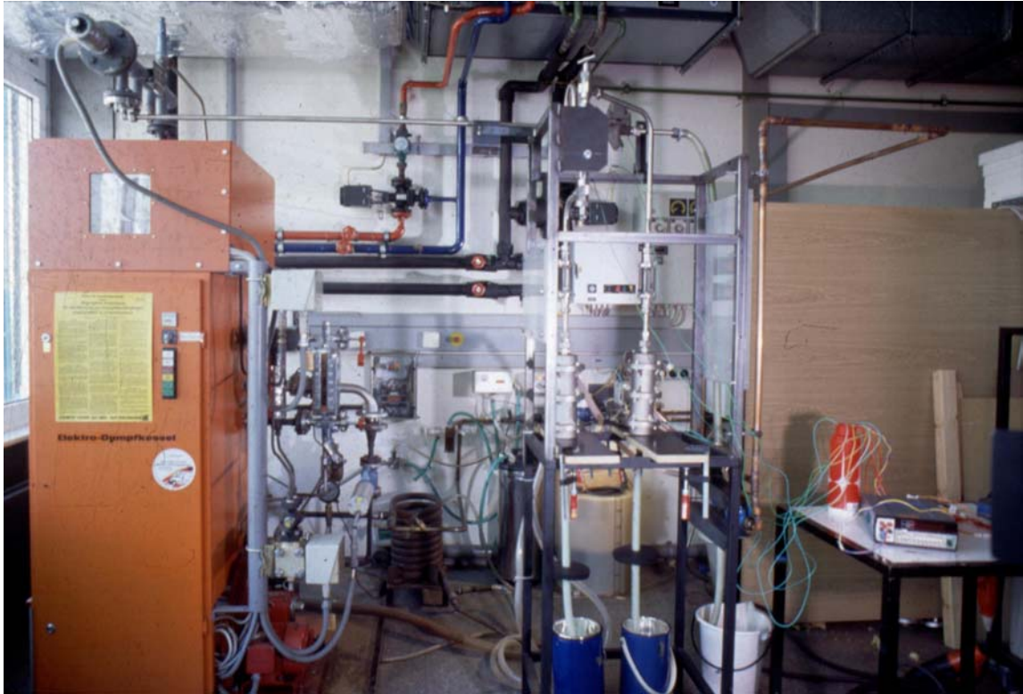
Fig. 7: Versuchsanlage zur Expansion von Wasserdampf bis p_{\max} = 20 bar im Wirbelrohr [26]. Das eigentliche Wirbelrohr ist in Bildmitte oben in lotrechter Anordnung zu erkennen. Links im Bild die Dampferzeugungsanlage.
