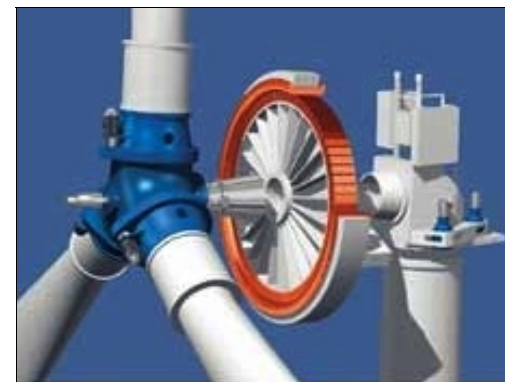
Abb. 1: Beispiel einer modernen getriebelosen (Rotor/Generator) Anlage, die u.a. zu einer deutlichen Senkung der mechanischen Beanspruchung der Bauteile führt.
