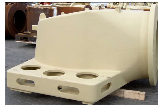
Abb. 2: Maschinenträger aus Stahl (oben) und aus Gusseisen (unten). Letztere führen zu einer merklichen Gewichtsersparnis, bei relativ geringem Produktionsaufwand.
