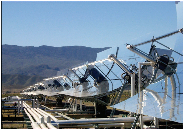
Abb. 4: 700 m Versuchsstrang eines direktverdampfenden Parabolrinnenkollektors auf der Plataforma Solar in Almería in Südsanien
