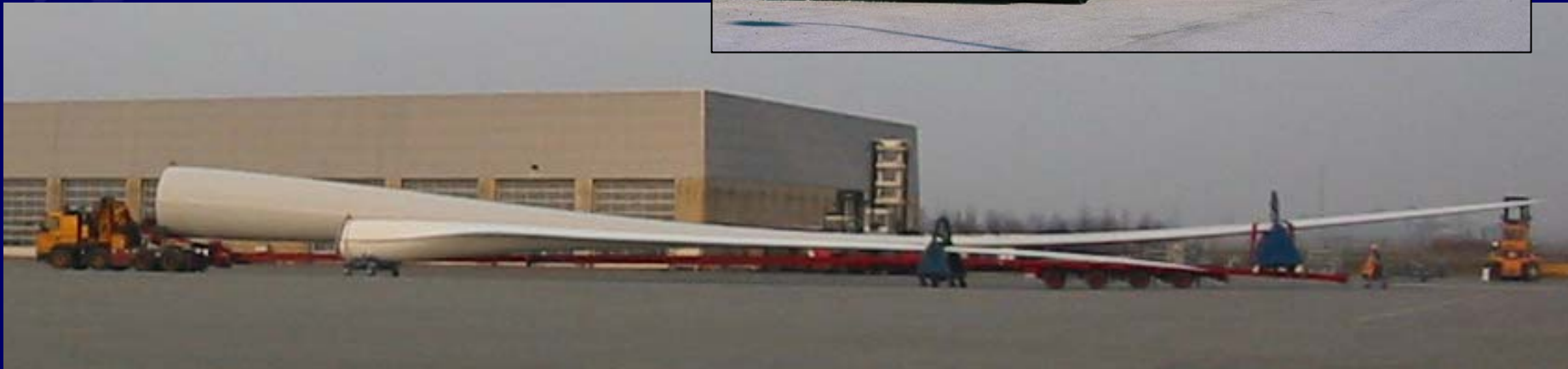
LM 61.5 hinter einem LM 37.5 Rotorblatt (Lunderskov)
