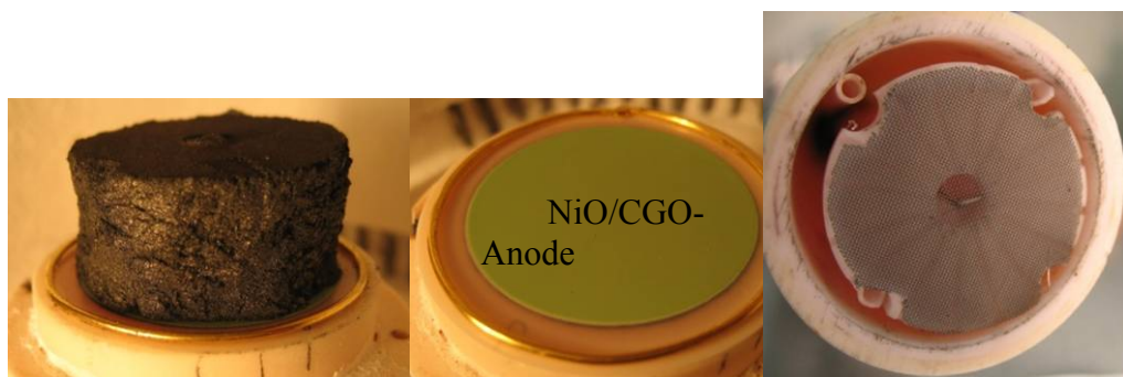
Abb. 2b: Detail der Anode der DCFC mit Kohlenstoffpressling auf einer Standardanode aus NiO/CGO und Detail der Kontaktierung mittels eines Nickelnetzes (rechts)
