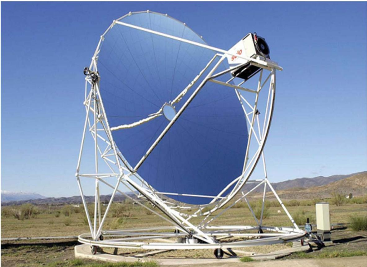
*Abbildung 5: Beispiel eines Dish-Stirling-Systems*
