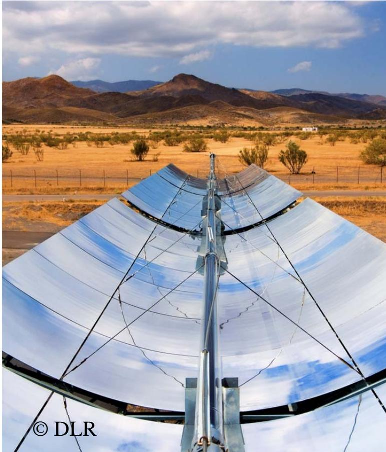
Abbildung 2: Beispiel einer Parabolrinne, Quelle: DLR
