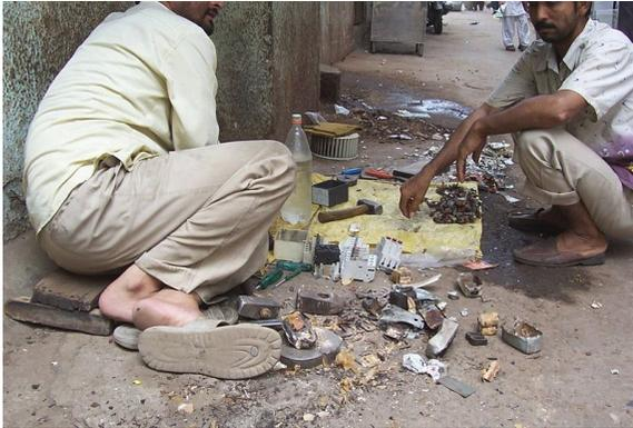
Recycling von Elektronik-Schrott in Neu-Dehli
