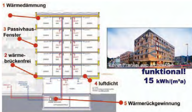
Abbildung 7: Die essentiellen Maßnahmen der Energieeffizienz am Beispiel eines Seminargebäudes der Universität Leoben [Feirer/Frankel 2017]: Es sind die Qualitäten der Gebäudehülle, welchen den entscheidenden Einfluss aufweisen [Feist 2018].
