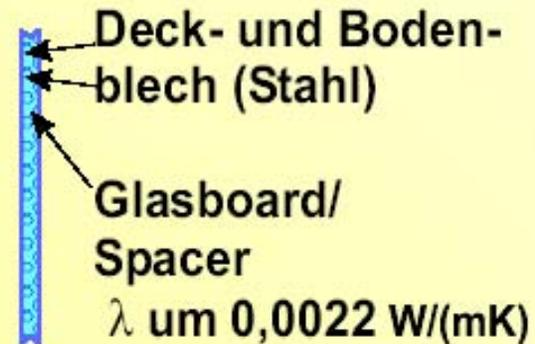
h) high-tech: Vakuumisolierung (2,5 cm)
