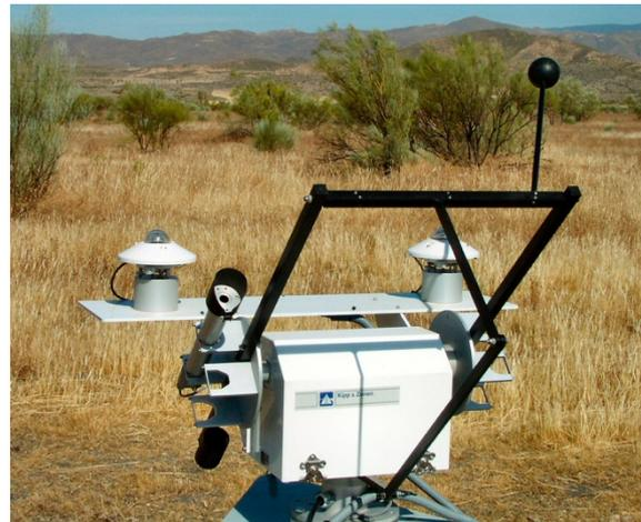
Abbildung 2-10 Messstation zur Messung der globalen, diffusen und direkten Bestrahlungsstärke. Links wird mit einem thermischen Sensor die globale Bestrahlungsstärke, rechts durch den Schattenball die diffuse Bestrahlungsstärke gemessen. Mit dem rohrförmigen Pyrheliometer wird die direkte Bestrahlungsstärke bestimmt. (Quaschnig, 2015, S. 93)
