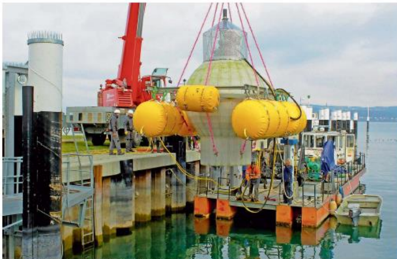
Mit diesem drei Meter messenden Prototyp wird die Technik der Unterwasser-Batterie im Bodensee getestet.
